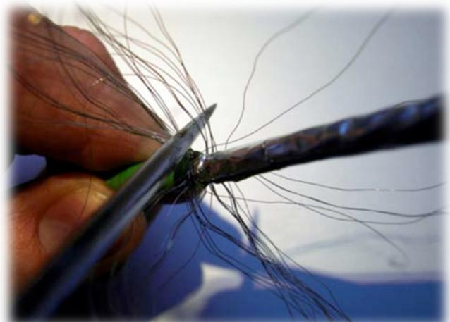
Ne pas couper le film en alu, mais le retirer en arrière de façon à ce qu'il recouvre le câble.
